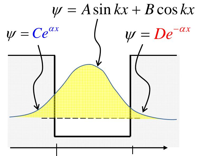
$$\begin{pmatrix} 1 & -1 & 0 \\ 0 & \alpha & 0 \\ \cos(ka) & 0 & e^{-\alpha a} \end{pmatrix} \begin{pmatrix} B \\ C \\ D \end{pmatrix} = \begin{pmatrix} 0 \\ -kA \\ -A \sin(ka) \end{pmatrix}$$
