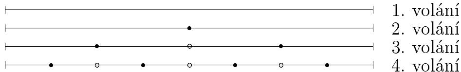
Podintervaly při jednotlivých voláních lichoběžníkového pravidla
